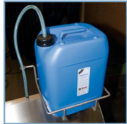
Tank für Reinigungsmittel Tank for cleaning fluid
