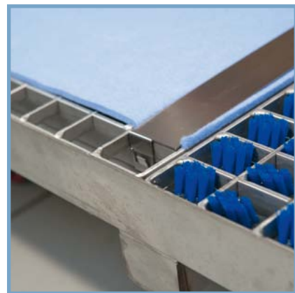
Das DryPad wird einfach mit 2 Klammern fixiert und ist schnell austauschbar / The Drypad is easily fixed with 2 clips and can be quickly replaced
