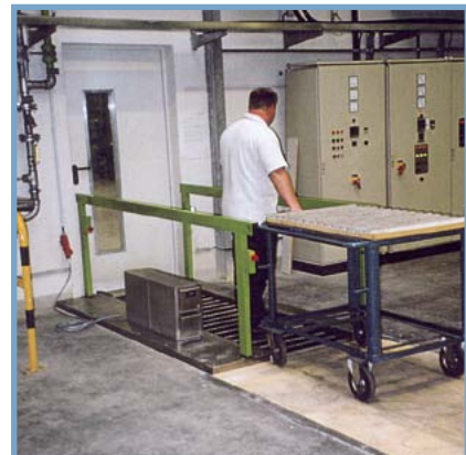
Trockenreinigung der Sohlen und Laufrollen Dry-cleaning of tires and soles
