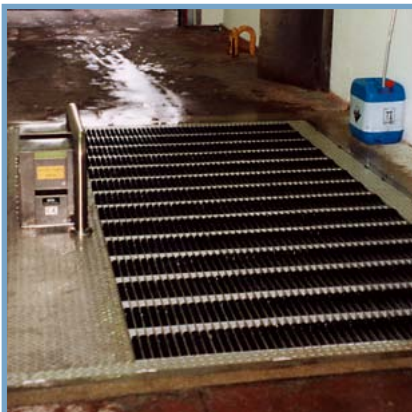
Nassreinigung mit Wasser und Zusatz eines Reinigungsmittels (bzw. eines Desinfektionsmittels) zur intensiven Reinigung Wet-cleaning with water and addition of detergent (or disinfectant) for intense cleansing
